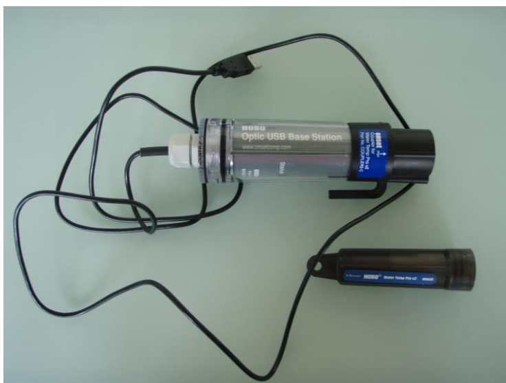
Figure 3.3: Enregistreur de température et interface de lecture
